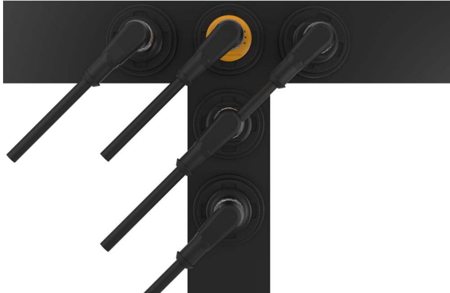
Bild 4: Bei der Anreihung von RAMO-Bedienelementen verhindern M12-Stecker mit um 135° gedrehten Kabelabgang die Überschneidung mit benachbarten Anschlüssen.
